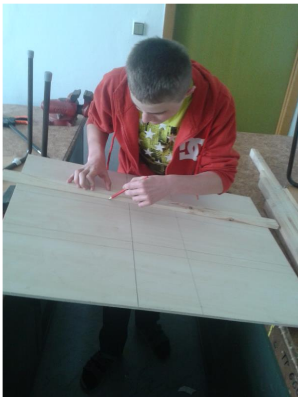
Rýsuji linku úhelnicí
