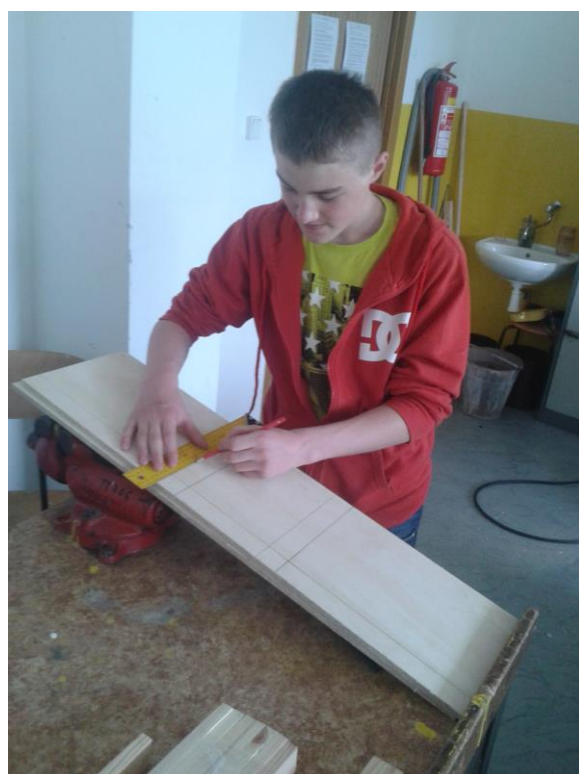
Rýsuji linku úhelnicí
