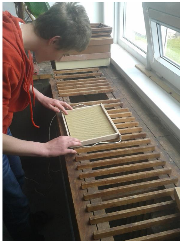
Zdroj vede na drátky el. proud, který nahřeje plástev
