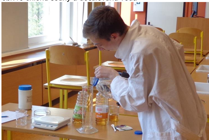
obr.11 odměřuji 150 ml destilované vody pomocí odměrného válce
