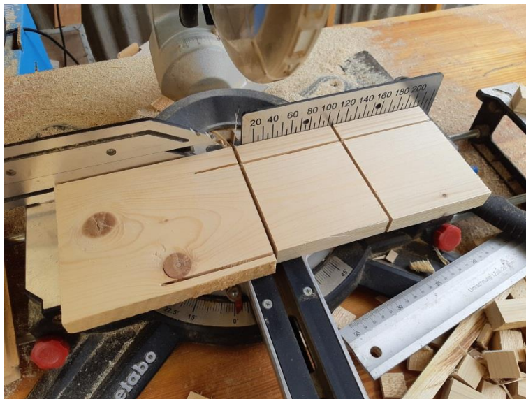
Obr. 9 Nařezání čtverců pro větší mosty
