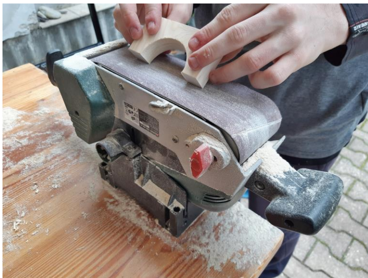
Obr. 14 Broušení smirkovým papírem Obr. 15 Broušení na pásové brusce
