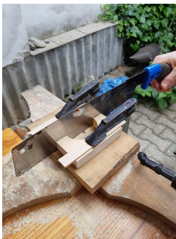
Obr. 11 Půlení na dva stejné mosty
