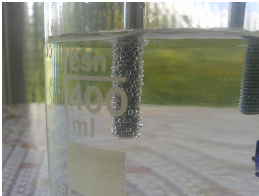
Obrázek č. 18: Detail katody, na které vzniká vodík
