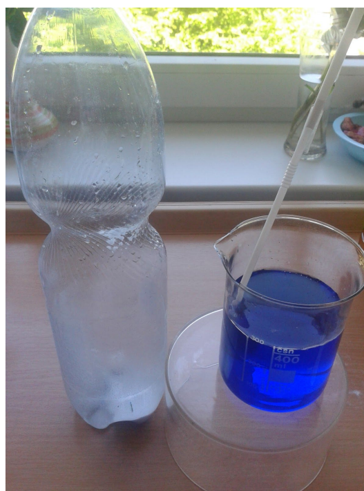
Obrázek č. 3: Sestavená aparatura k výrobě CO 2
