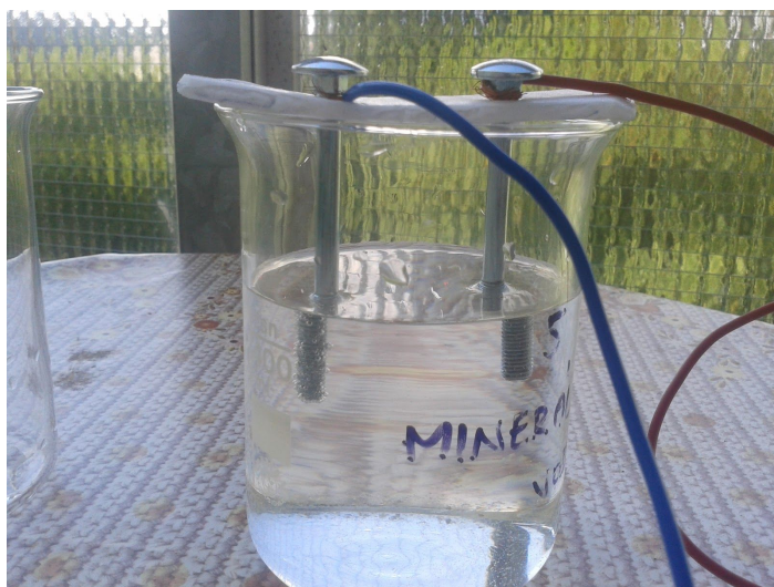
Obrázek č. 17: Při elektrolýze začali na elektrodách vznikat bublinky
