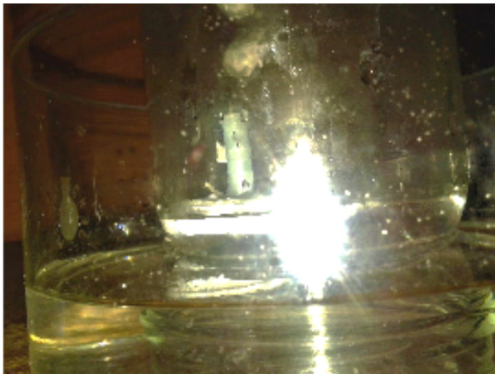
Obrázek č.15: Svíčka zhasla a místo kyslíku se do sklenice vlivem podtlaku vtlačila voda
