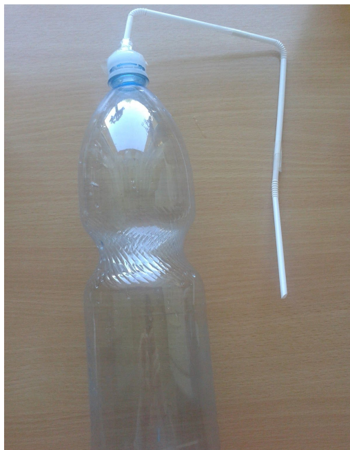
Obrázek č. 2: PET láhev uzpůsobena k přípravě plynů
