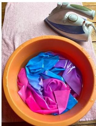
Obr. 9 – zkouška stálosti barev po zažehlení
