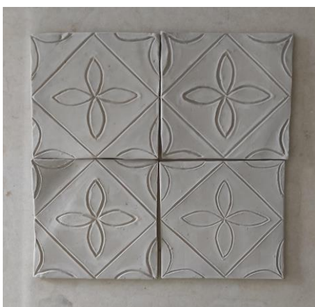
obr. č.6 Kachle po 10 dnech vysychání
