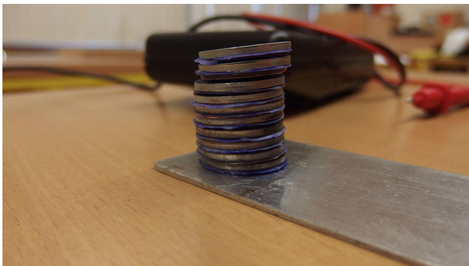
Obrázek č.10 Deset článků zapojených v sérii
